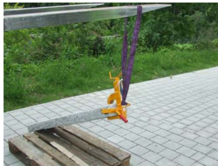
Mittels Schlaufe wird der Stelensetzer an ein Trägergerät angehängt
