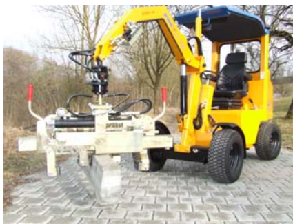
VZ-H uni an Verlegemaschine VM 203/VM 204
