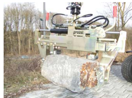
VZ-H uni, ausgestattet mit Felsgreifbacken
