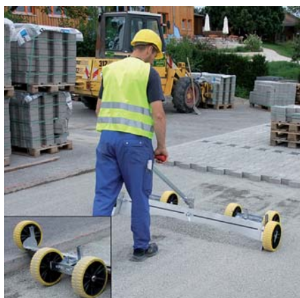
LF-125/215. En bas à gauche : Réglage en hauteur de la roue
