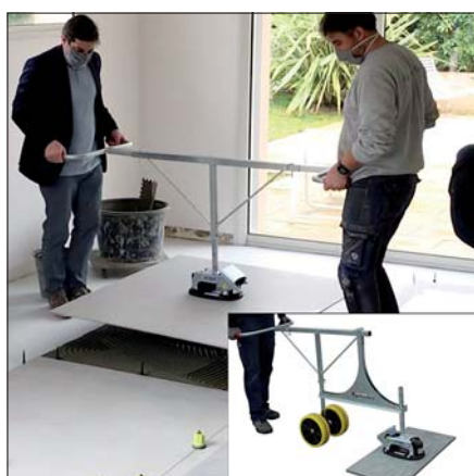
FXAH-120-GRABO-GREENLINE avec FXAH-120-DUO-Set, en bas à droite : en plus avec jeu de roues VPH-RS
