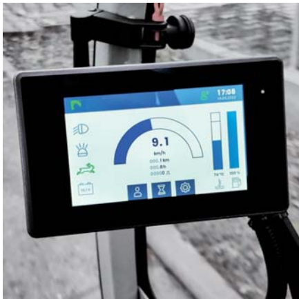
Écran tactile couleur LCD LED avec affichage des données en temps réel et pour la sélection des programmes automatiques, des profils de conduite, ...
