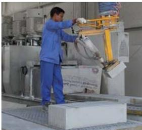
Platine d'aspiration avec système de retournement pneumatique ESP-SW-P
