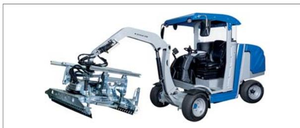
VM-X-PAVERMAX standard Machine pose-pavés avec HVZ-UNI-II
