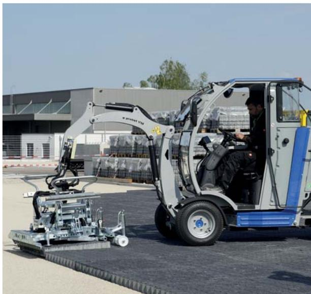
VM-X-PAVERMAX premium Machine pose-pavés avec HVZ-UNI-II
