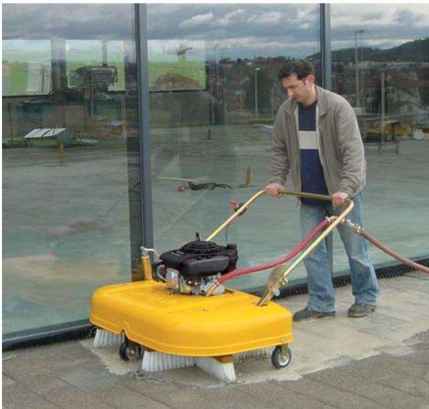
EASYFILL EF-H Outil de jointoiement de pavés
