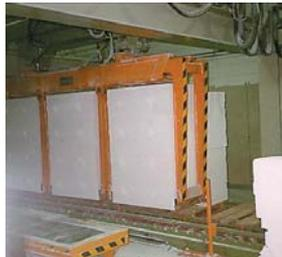
Pince pour paquets de matériaux avec lame intermédiaire hydraulique
