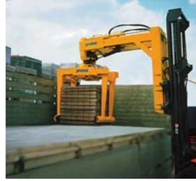
Pince hydraulique avec flèche télescopique STAZ+KA+VA
