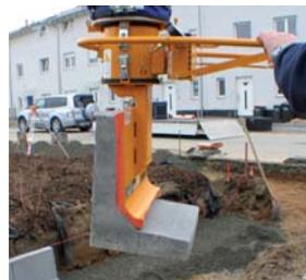
Platine d'aspiration de surface pour colonne d'élévation
