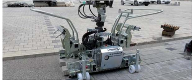
HVZ-GENIUS-II Pince hydraulique pour pavés pour une utilisation universelle sur excavateur
