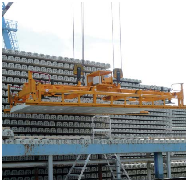
Beton áthidaló megfogyó
