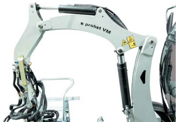
premium Variante: Knickausleger mit zwei Gelenken erhöht die Reichweite
