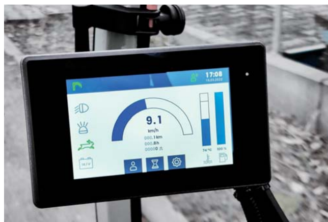
Farb-LCD-LED-Touchscreen mit Anzeige von Echtzeitdaten und zur Auswahl der Automatikprogramme, Fahrprofile, ...
