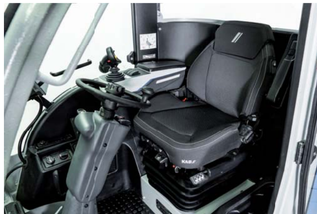
Entkoppelte Fahrerkabine mit luftgefedertem Komfortsitz, Sitzheizung und Längsdämpfung
