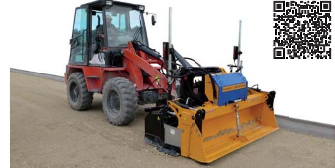
Im Gegensatz zu herkömmlichen Planierschildern arbeitet der LEVELKING LK mit einem integrierten Ableitblech. Damit lässt sich neben dem Grobplanum auch das Feinplanum für Pflasterbeläge schnell, exakt und vollautomatisch gesteuert erstellen – mehrfache Überfahrten sind nicht notwendig. Das macht den LEVELKING LK zu einer effizienten und günstigen Alternative.
