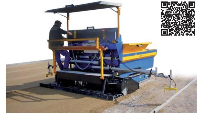
Ob Unterbau, Bettung, Schotter, Split, Sand oder erdfuchter Beton, der POWERPLAN PP übernimmt den Einbau und das Nivellieren des entsprechenden Materials in einem Arbeitsgang (bis zu einer Einbauhöhe von 20 cm) – auf der absolut korrekten Höhe. Je nach Höhenprofil und Steuerungsart können pro Tag zwischen 2.500 qm (Ultraschall-Steuerung) und bis zu 10.000 qm (Lasersteuerung) eingebaut werden.
