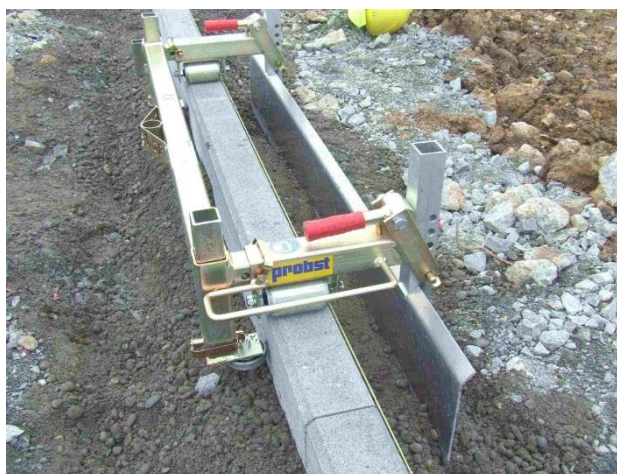
Стояночный тормоз в вертикальном положении для перемещения GR150 по бордюру.
