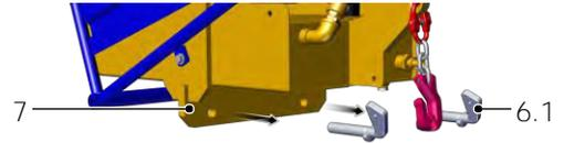
2. Beide Sicherungsbolzen (6.1) entfernen.
