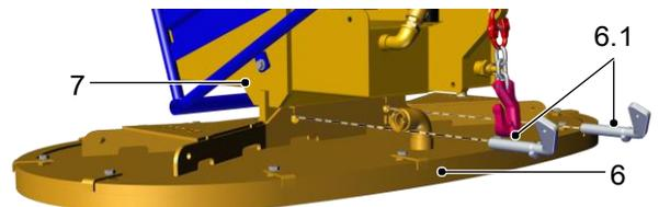
5. Beide Sicherungsbolzen (6.1) in Pfeilrichtung drehen, so dass die Auskrägung sicher hinter dem Haltwinkel klemmt.
