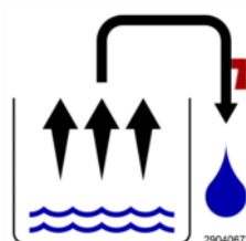
Tappe av kondensvann daglig 2904.0673
