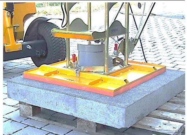
25. Gerät mit angesaugter Last nur ein wenig anheben (ca. 20-30 cm), dann Lastsicherungskette aus Kettenkasten entnehmen (↻) und unter der angehobenen Last durchwerfen(durchführen) ...
