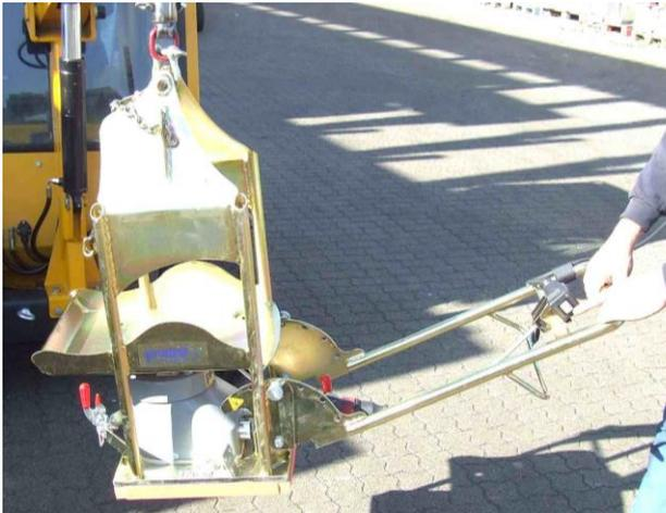
21. För att låsa handtaget drar du ut båda fjäderlåsen (till höger och vänster om enheten) en aning, vrider dem och släpper dem igen tills de går in i varandra.
