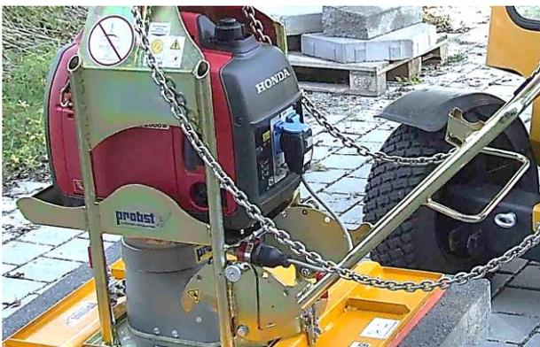
9. Gummiband zur Sicherung des Stromerzeugers unter dem Transportgriff (des Stromerzeugers) durchziehen u. an in beiden dafür vorgesehenen Haken an Gerätekonstruktion einhängen (↘ ↘)
