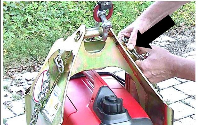
28. Lastsicherungskette muss straff an Last anliegen, damit **Last bei Vakuumausfall (z.B. bedingt durch Stromausfall)** durch die Lastsicherungskette gehalten wird.
