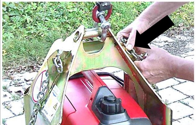
4. Lastsäkringskedjan ska vara tätt mot lasten så att [lasten hålls kvar av lastsäkringskedjan i händelse av vakuumfel (t.ex. på grund av strömavbrott)].
