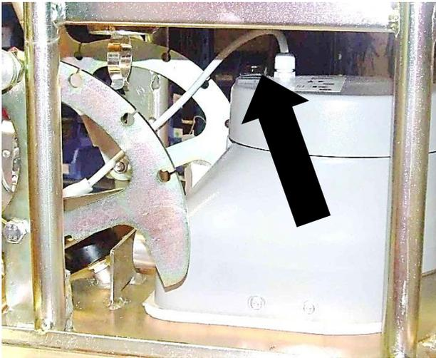
23. Lasten (stenplatta) sugas in via kabelkontakten (med integrerad ON/OFF-omkopplare) på handtaget. (⬇️).
