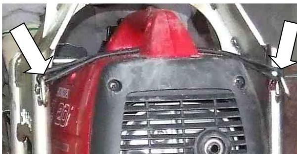
11. Verbindungsstecker (mit integriertem EIN/AUS-Schalter) in eine der beiden Steckdosen am Stromerzeuger einstecken. (↙).
