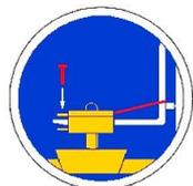
Einstecktasche und Gabelstaplerzinken mittels Arretierungsschraube und Sicherungskette oder Seil sichern.
