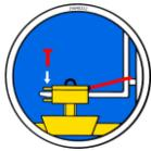
För att skapa en säker förbindelse mellan gaffeltrucken och insättningsfickan (3) sätts gaffeltruckens tänder (1) in i insättningsfickan (3).
