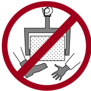
Gliedmaßen nicht unter die angehobene Last halten! Verletzungsgefahr!
