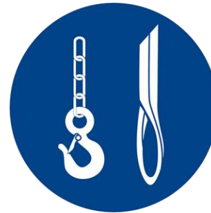
Erlaubte Anschlagmittel: Haken und Lasthebeband.
