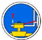
Um eine sichere Verbindung zwischen dem Gabelstapler und der Einstecktasche (3) herzustellen, fährt man mit den Gabelstapler-Zinken (1) in die Einstecktasche (3) hinein.
